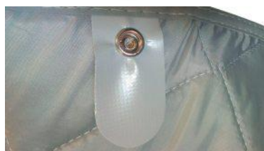
Fixation sur le toit relevable par bouton-pression
